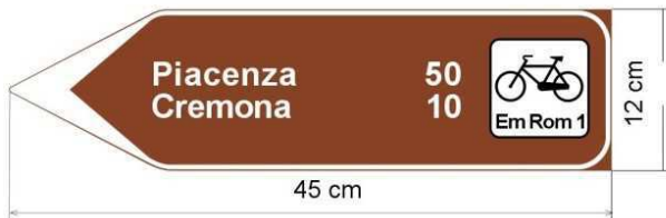
Fig 1: Segnale di direzione per contesti extraurbani per viab. riservata (riduzione da segnale tabella II 14a DPR 495/92)
