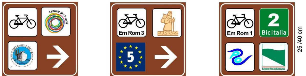
Fig 3: Segnalini di conferma composti per viabilità riservata (grande 40 cm di lato e piccolo 25 cm: figura II 261 art 129 DPR 495/92 )
