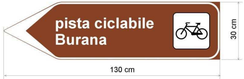
Fig 1: Segnale di direzione per avviamento a itinerario ciclop. ottenuto dai segnali turistici per contesti extraurbani (Tabella II 14a DPR 495/92)
